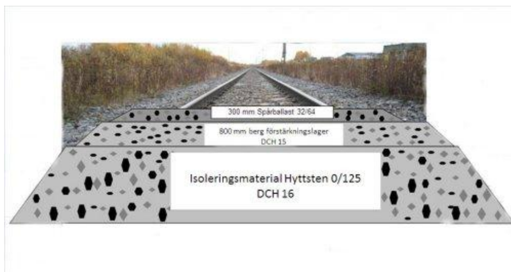
Figur 4 Generell uppbyggnad av järnväg
